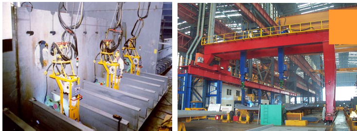
그림 4. 조선용으로 특수 개발한 고성능 자동 용접 로봇
